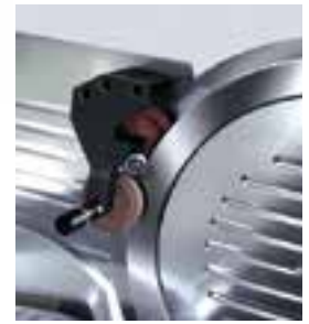
Affilatoio amovibile alloggiato sotto la base. Removable sharpener put under the base.
